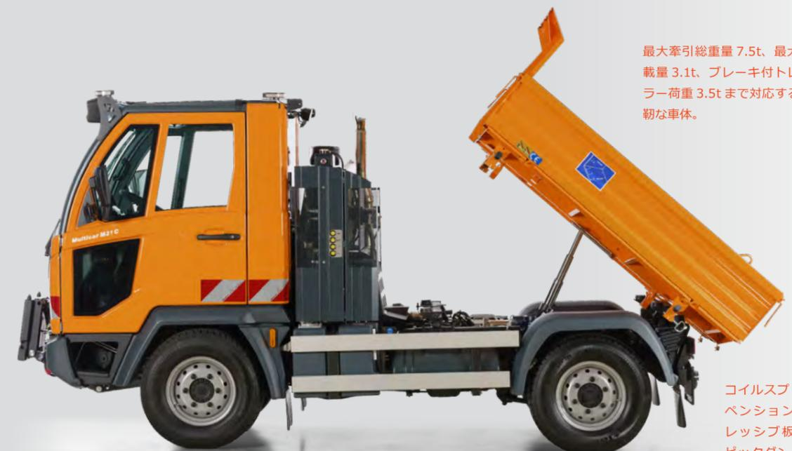
最大牽引総重量7.5t、最大積載量3.1t、ブレーキ付トレーラー荷重3.5tまで対応する強靱な車体。
