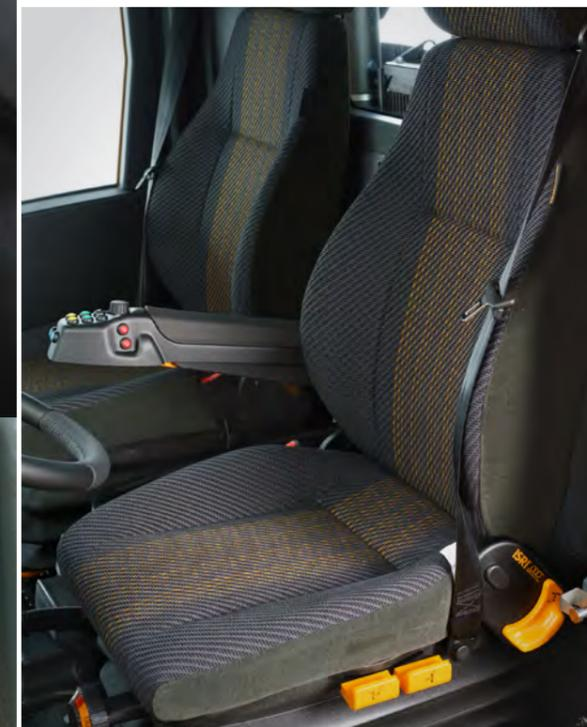
シートクッション内蔵のセンサーがドライバーや同乗者の有無をチェックし、さらにシートベルトのバックル内蔵のスイッチがシートベルトを締めているかを確認します。シートベルトが締められていない場合、インジケーターや警告音が発生します。
