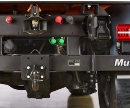
パワフルなボールヘッド/ピンカップリングは、それぞれ150kgと250kgの牽引負荷（垂直荷重）に対応します。
