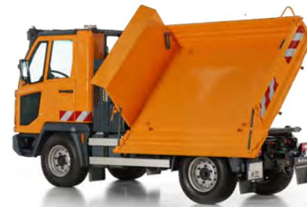
3点ダンプにより、方向可変油圧式ティッピングが可能。
